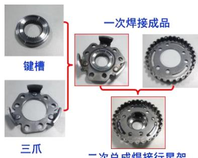
图 1 汽车变速箱行星架激光焊接
