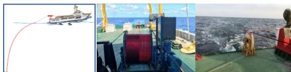
系统示意图、海试中的绞车系统和拖曳链
