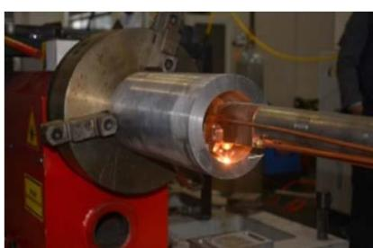
图 3 激光内孔熔覆修复
