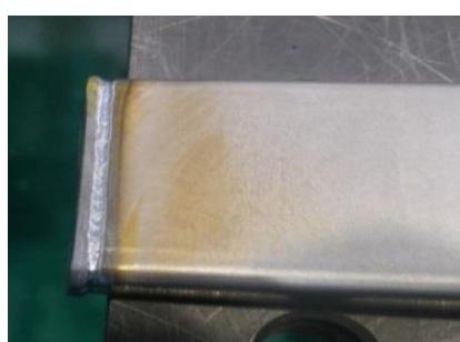
图 2 奔驰汽车天窗滑轨激光焊接
